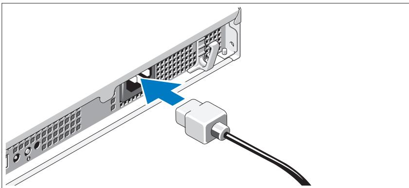
Připojte napájecí kabel k systému, a pokud používáte monitor, připojte napájecí kabel také k monitoru.
