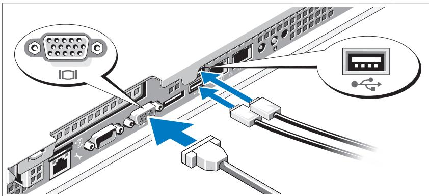
Подключите клавиатуру, мышь и монитор (дополнительно).
