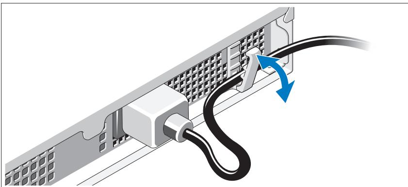
Pliez le câble d'alimentation comme le montre l'illustration et faites-le passer dans le clip de fixation.
